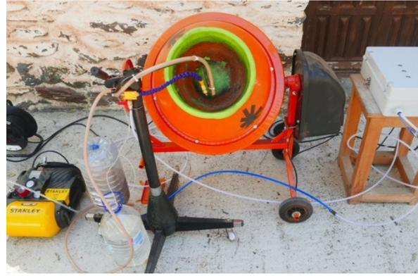
Abbildung 6: Der Betonmischer für die Pelletierung von Saatgut (Foto: übernommen mit Erlaubnis von Dronecoria)
